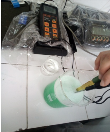
Figure IV. 7-la mesure de pH par pH-mètre
