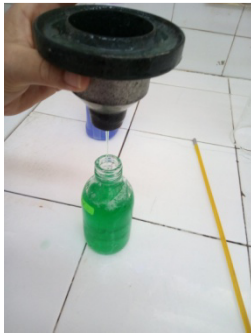
Figure IV.9-détermination de taux d'écoulement
