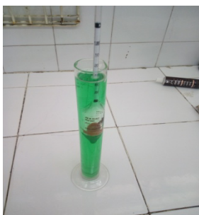
Figure IV. 8-La détermination de la densité
