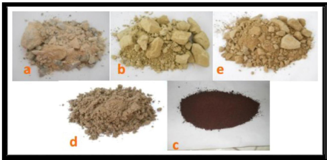
Figure. II.1 : Matière premières constituant le ciment ; a)calcaire, b) argile, c)schiste, d)sable, e) minerai de fer.
