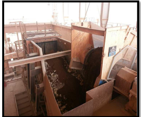
Figure. II.6: Concassage des matières premières au niveau de la carrière.
