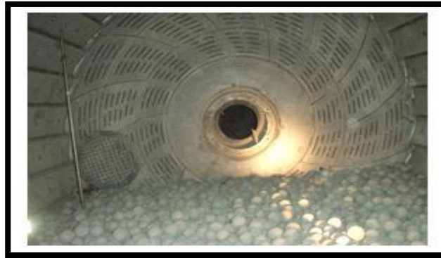
Figure. II.10: Intérieur d'un broyeur à boulets.
