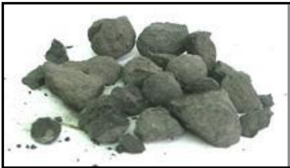
Figure. II.9: Granulés de clinker prêt à être broyé.
