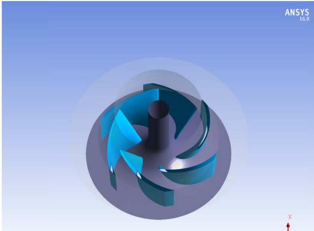
Figure IV. 4. Notre modèle géométrique de la roue à aubes.
