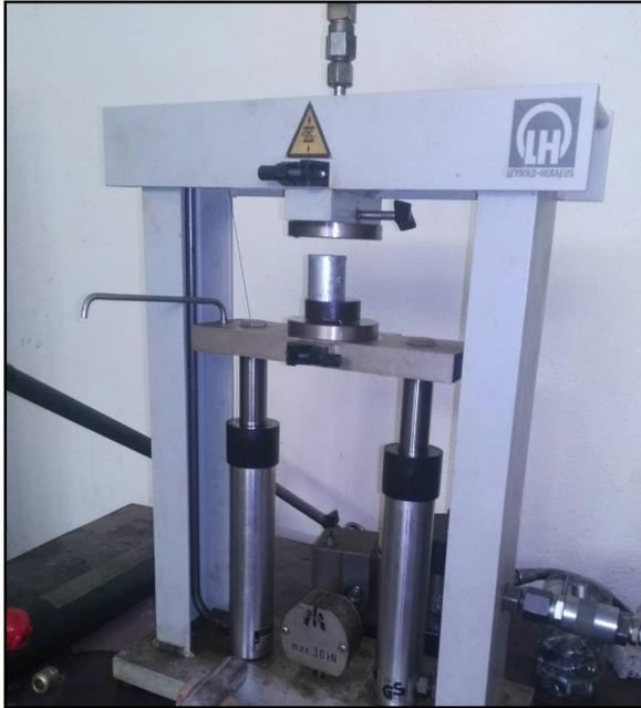
**Figure II-1** : Dispositif de compression uni-axiale.
