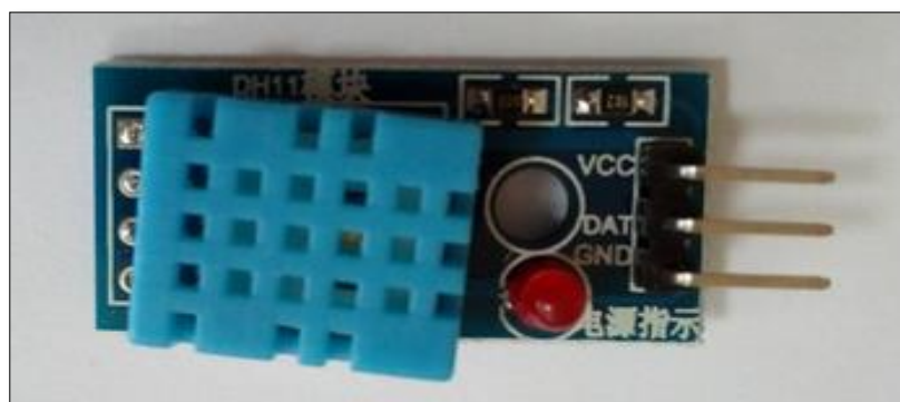
Figure II.15 : Capteur de température et d'humidité DHT11.
