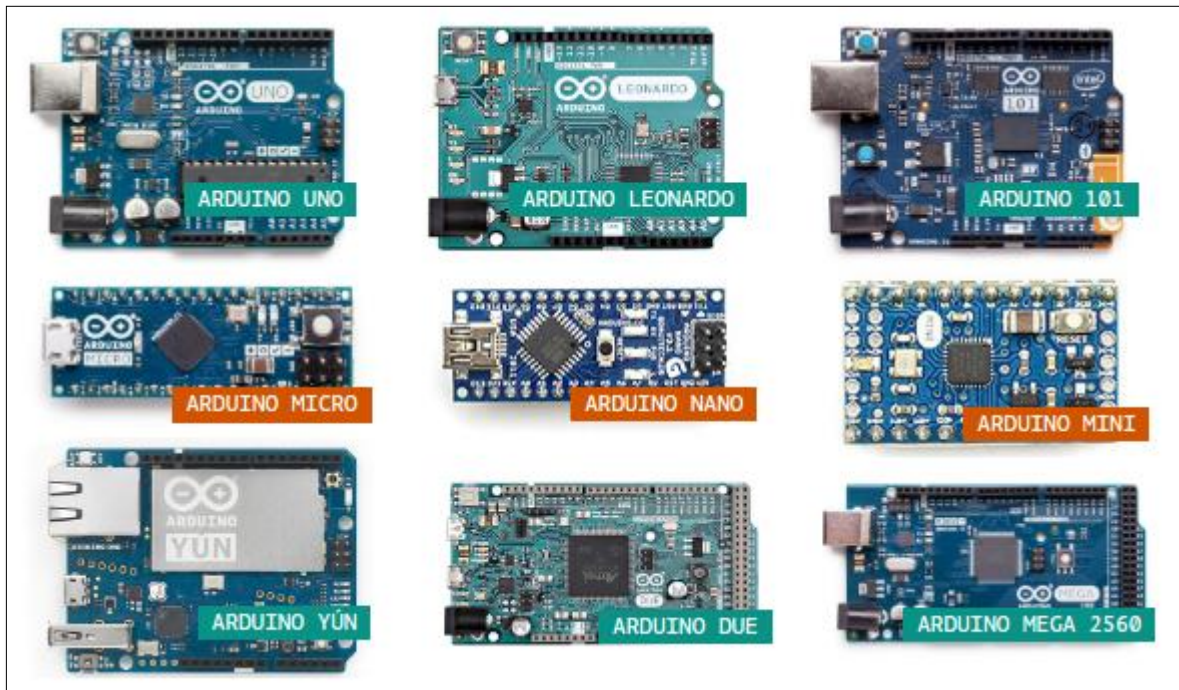
Figure II.3 : Les différentes cartes d'Arduino [18].
