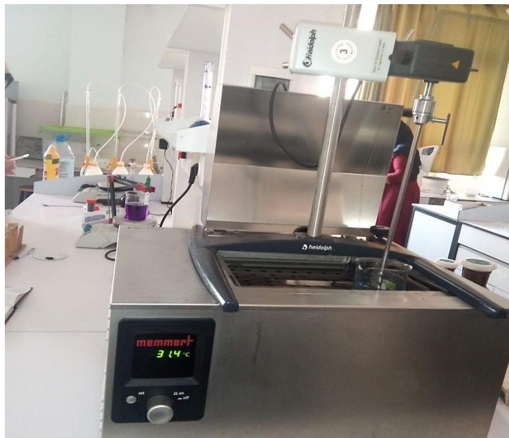
Figure III.11 : Installation de mise en œuvre du procédé d'adsorption.
