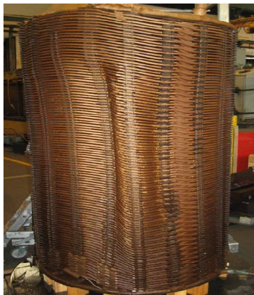
Figure(I.17): Déformation mécanique d'un enroulement. [2]
