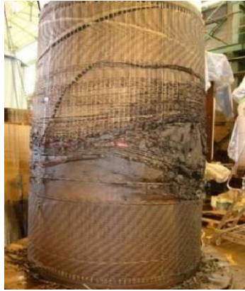
Figure(I.14) : Amorçage franc entre spires.[2]
