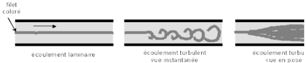
**Figure I.1. Les différents régimes d'écoulement**
