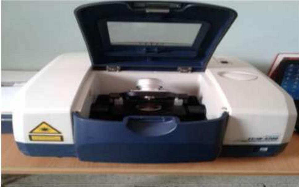
**Figure.III.4.** Spectroscopie Infrarouge à Transformée de Fourier (FTIR).
