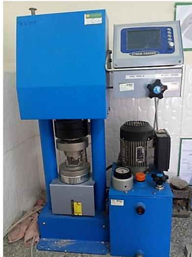
**Figure IV. 9:** Machine d'essais de flexion et de compression pilotée par ordinateur (L.C.T.P).
