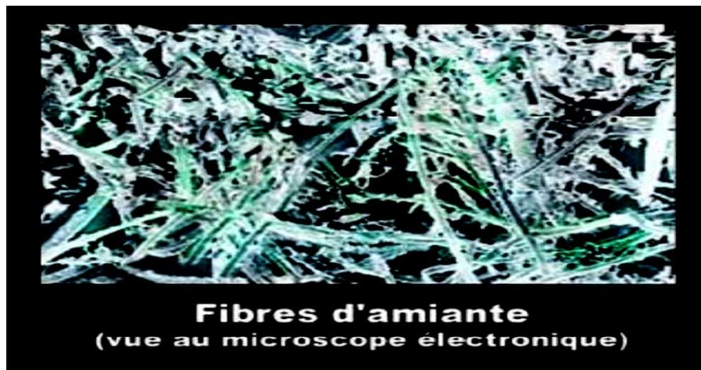
**Figure II. 1:** Vue microscopique de fibres d'amiante [14]
