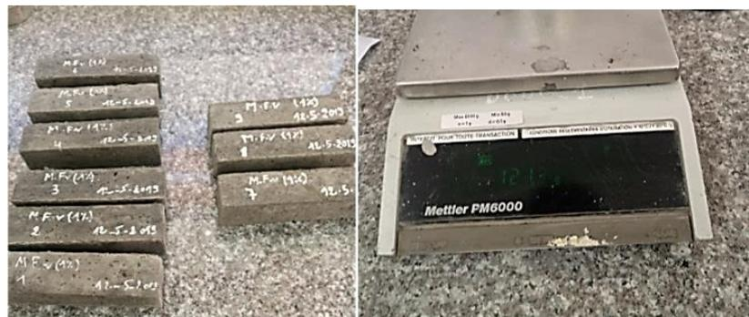
**Figure IV. 8:** Mesure des masses volumiques des éprouvettes.
