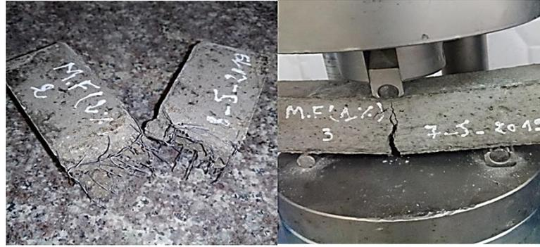
**Figure IV. 20:** éprouvette après test de flexion.
