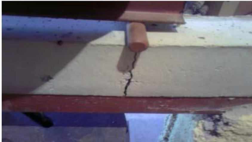
**Figure III. 15:** Fissuration et rupture d'une poutrelle
