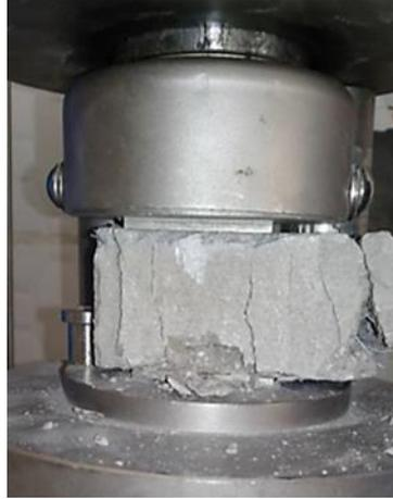
**Figure IV. 21:** Eprouvette après test de compression.
