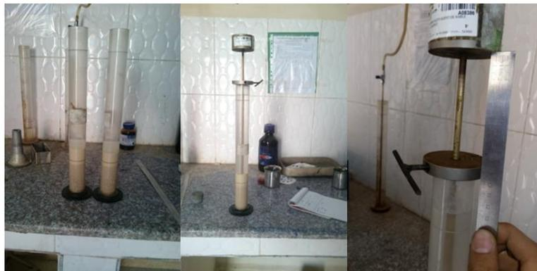
**Figure IV. 4:** Essai d'équivalent de sable.
