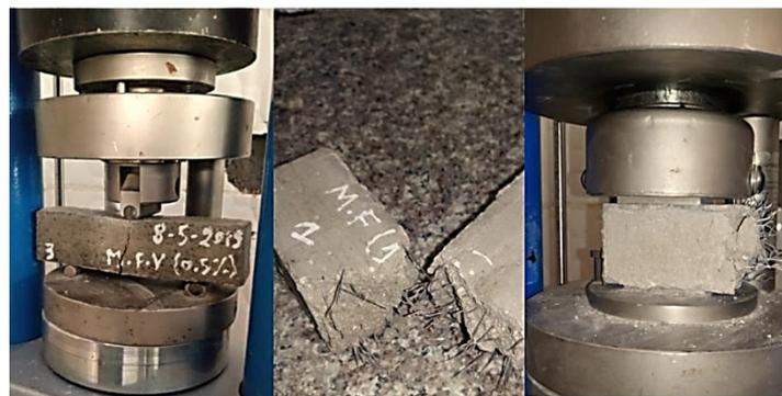
**Figure IV. 10:** Essais de flexion et compression (L.C.T.P).
