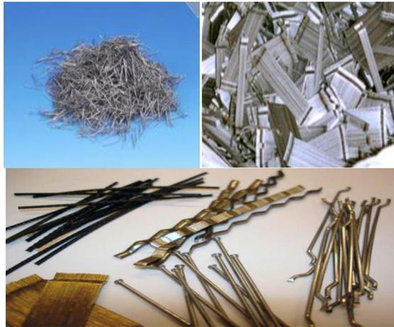
**Figure II. 5:** Différentes formes de fibres métalliques [17].
