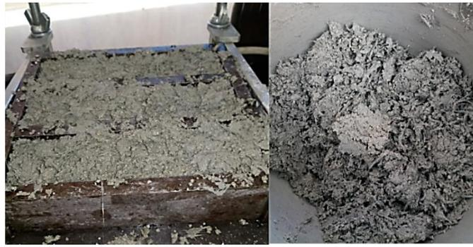
**Figure IV. 11:** Phénomène d'enchevêtrement du mélange avec 2 % de fibre de verre.
