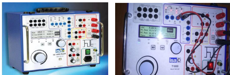
Figure 4-2 : Caisse d'injection pour les départs 30KV
