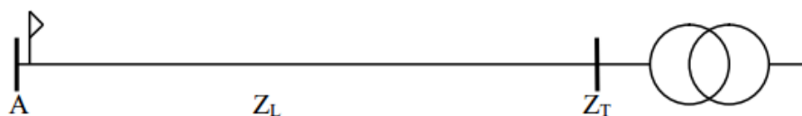
Figure 2-2 : Zone de réglage protection ligne en antenne
