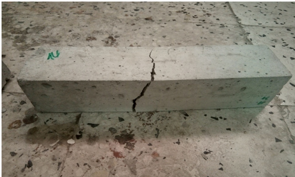
Figure I. 1: Une éprouvette fissurée due au phénomène de fatigue.
