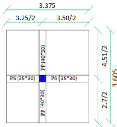
Figure II.15: Schéma indique le poteau central le plus sollicité.
