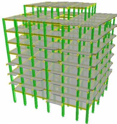
**Figure IV.2** Modèle 3D du bâtiment (sans voiles)
