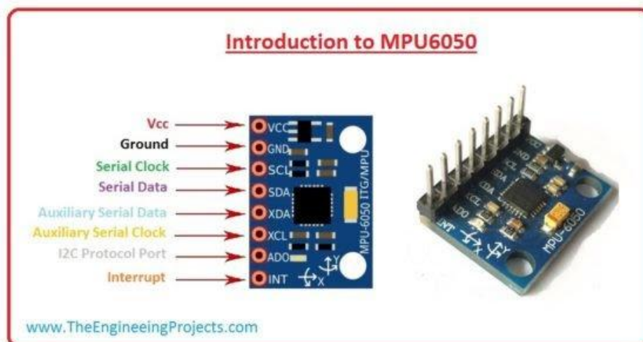
Figure III.3 : Une carte GY-521 dotée de la puce MPU6050 et son branchement.
