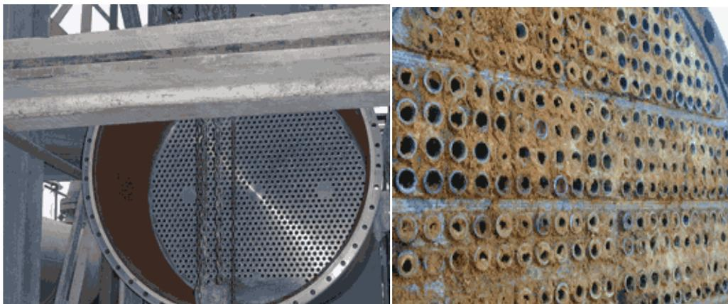
**Figure II.12** :Echangeur sale et propre
