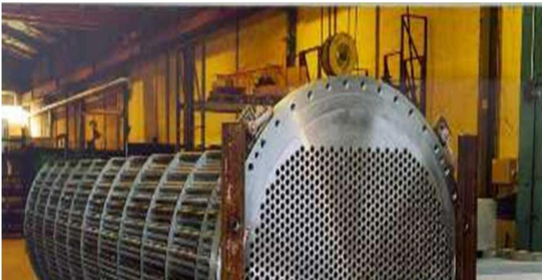
**Figure I.13** : Préchauffeur de la colonne de stabilisation
