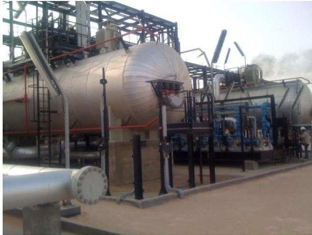
**Figure I.11** : Dessaleur 1<sup>er</sup> et 2<sup>ème</sup> étage
