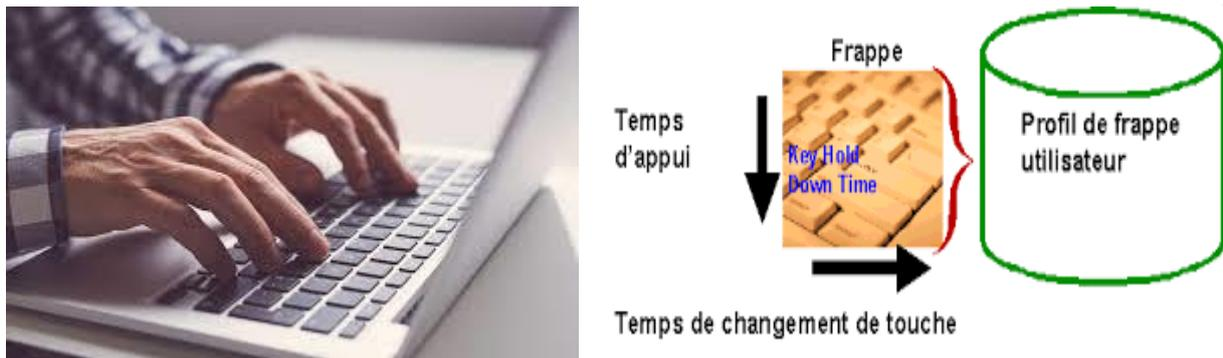
**Figure.I.11:** Système biométrique basé sur la dynamique de frappe au clavier.
