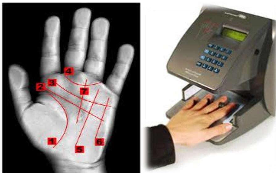
**Figure.I.6:** Système biométrique basé sur la géométrie de la main.
