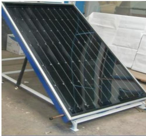
**Figure III.6 : Capteur plan. [22]**
