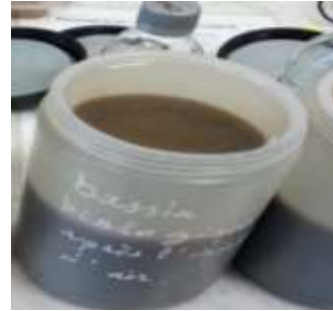
Figure 36:échantillon de bassin biologique après injection d'air
