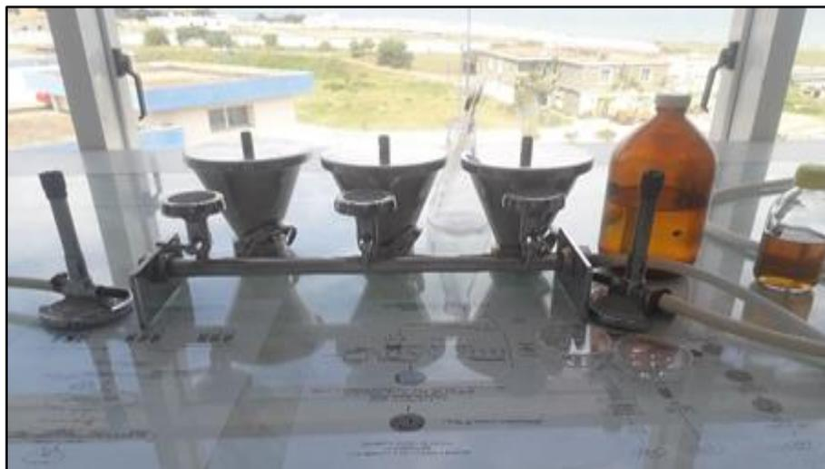
**Figure II. 19 :** Filtration sur membrane
