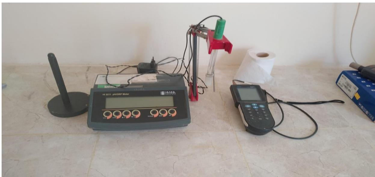
Figure II. 6: pH-mètre et conductimètre de la STEP de Médéa
