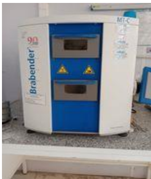
Figure VI.1 : Etuve Appareil Barbender
