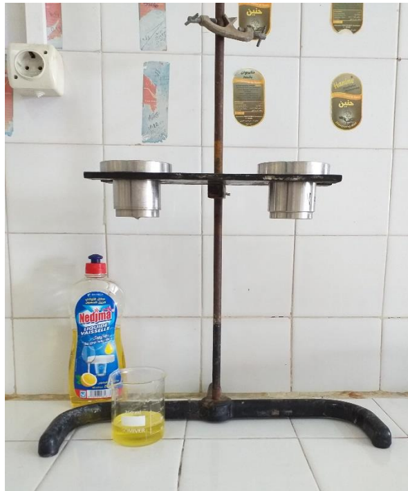
Figure II.9 : Mesure de la viscosité de produit fini à l'aide de coupe de viscosité Ford.
