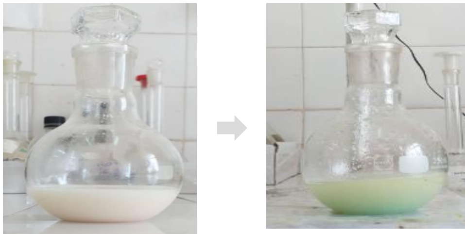
Figure II.10 : Couleur de la solution titrée avant (gauche) et après (droite) le point d'équivalence.
