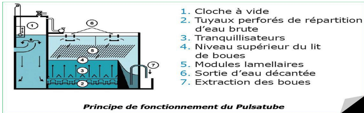
Figure II. 9: Schéma des principaux constituants de pulsateur lamellaire [4]
