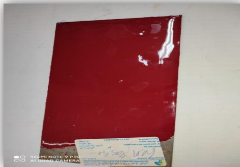
Figure III-12 : Test de résistance à l'acide sulfurique pour le cas du primaire.
