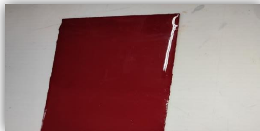
Figure III-6 : Test de résistance à l'éthanol pour le cas du système.
