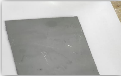
Figure III-7 : Test de résistance à l'acétone pour le cas du primaire.
