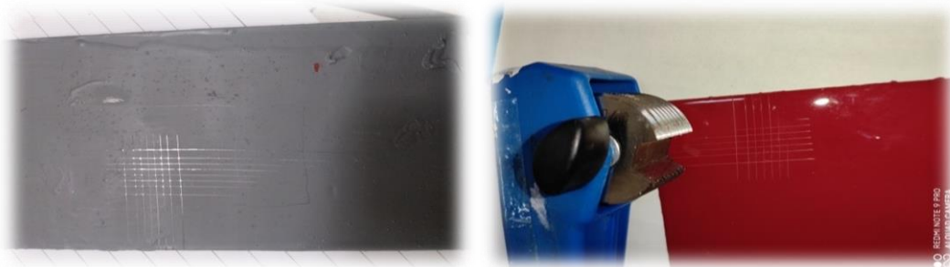
Figure III-4 : Test d'adhérence pour les deux cas.
