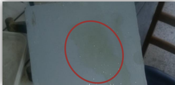
Figure III-11 : Test de résistance à l'acide sulfurique pour le cas du primaire.
