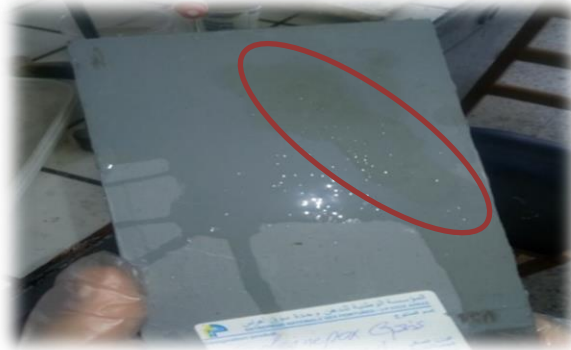
Figure III-13 : Test de résistance à la soude pour le cas du primaire.
