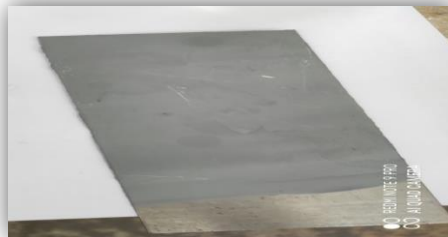
Figure III-5 : Test de résistance à l'éthanol pour le cas du primaire.
