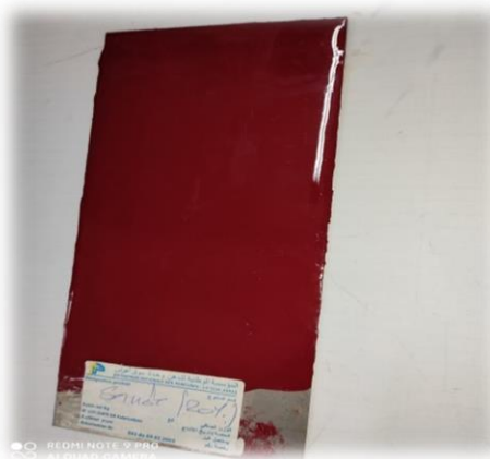
Figure III-14 : Test de résistance à la soude pour le cas du système.
