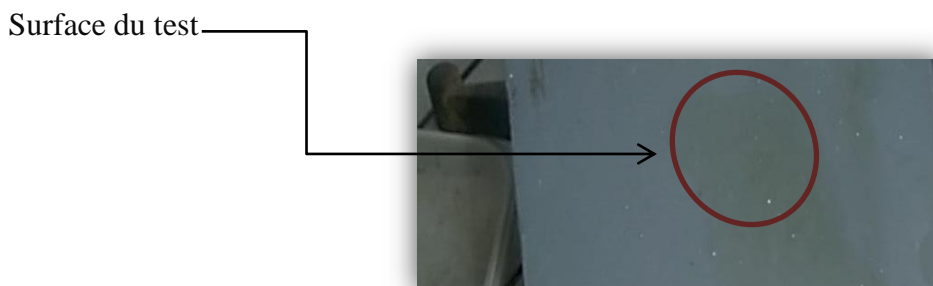
Figure III-9 : Test de résistance à l'acide chlorhydrique pour le cas du primaire.
