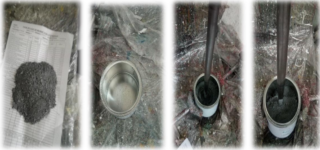
Figure II-13 : Fabrication du "GALZINEPOX Gris".
