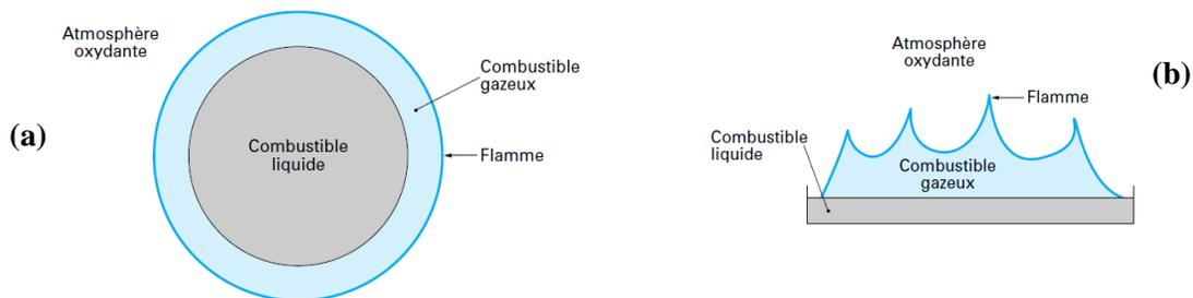
**Fig.7-2 :** (a) Combustion d'une goutte de combustible dans une atmosphère oxydante, (b) Feux de nappes
