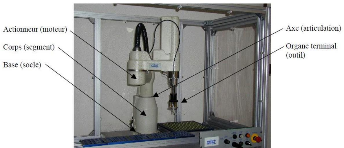
**Figure 1.17:** Constituant d'un robot [10].
