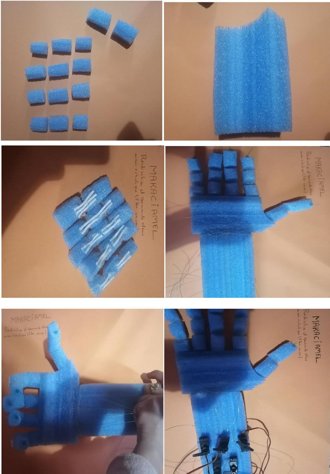
**Figure4.1** : les étapes de la réalisation de la main 3D.
