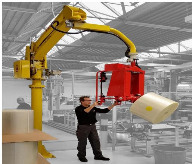
**Figure 1.18:** Manipulateur à commande manuelle [8].
