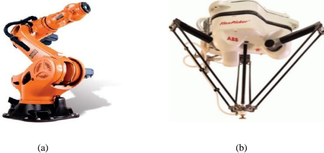
**Figure 1.14:** De gauche à droite : (a) Bras Manipulateur série, (b) Bras Manipulateur parallèle [8].
