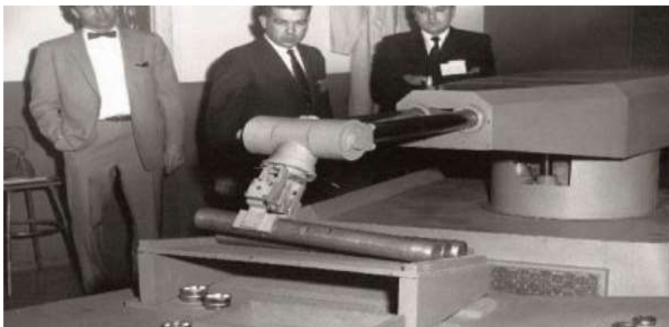
Figure I.3 : UNIMATE : le premier robot industriel [15].
