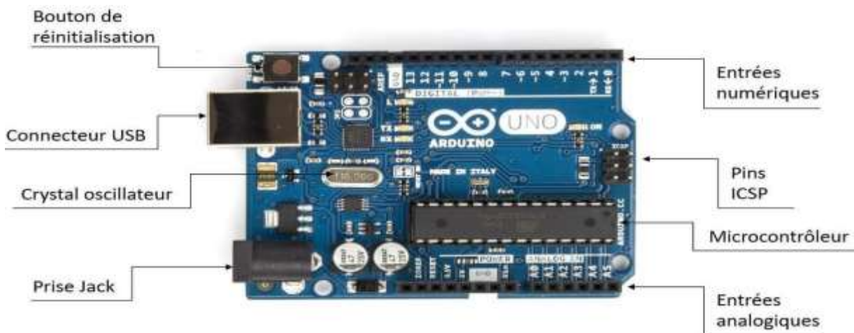
Figure II.2 : Constitution de la carte Arduino Uno [20].
