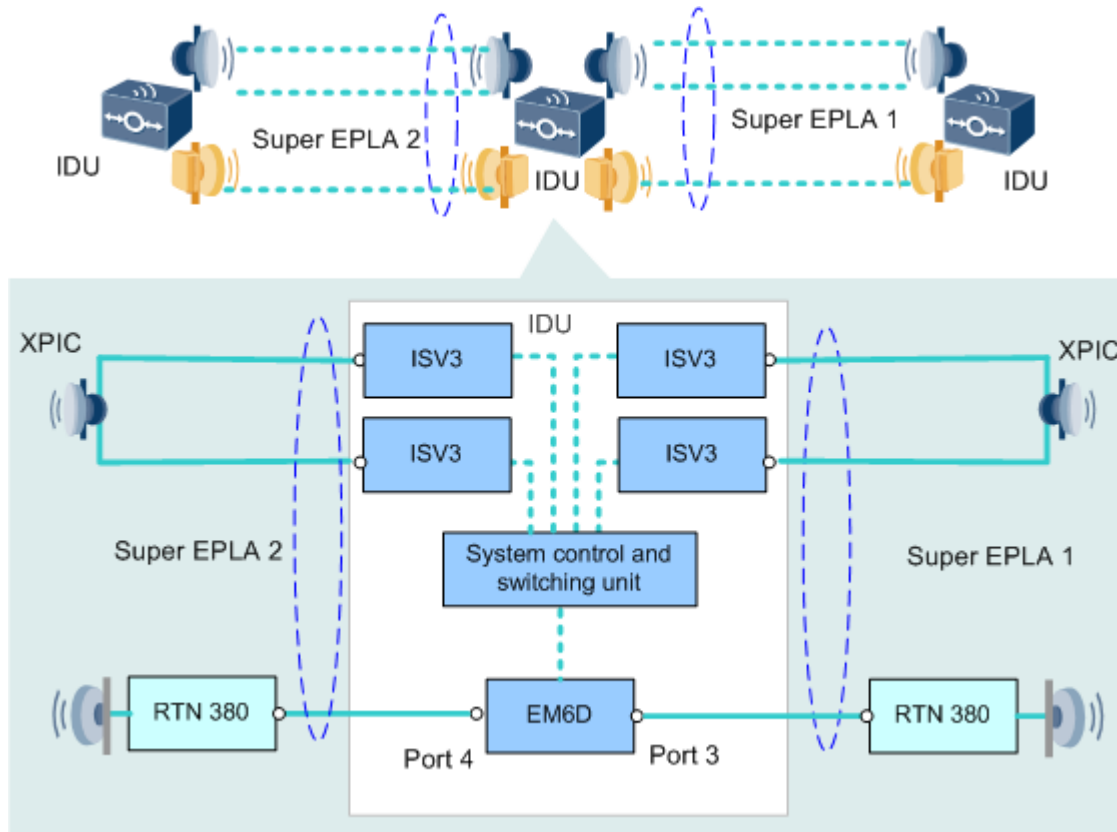
Figure III.6 : Configurations système typiques pour la transmission de relais intra-carte
