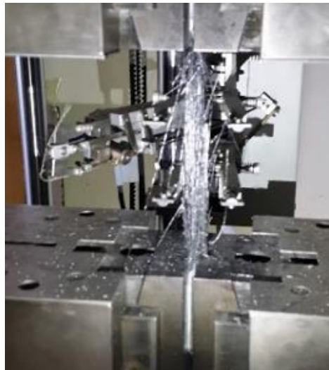
Figure 40. Rupture d'éprouvette après traction
