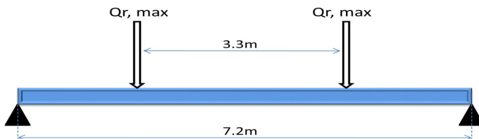
**Figure IV.9 : Disposition des charges des galets sur la poutre de roulement.**
