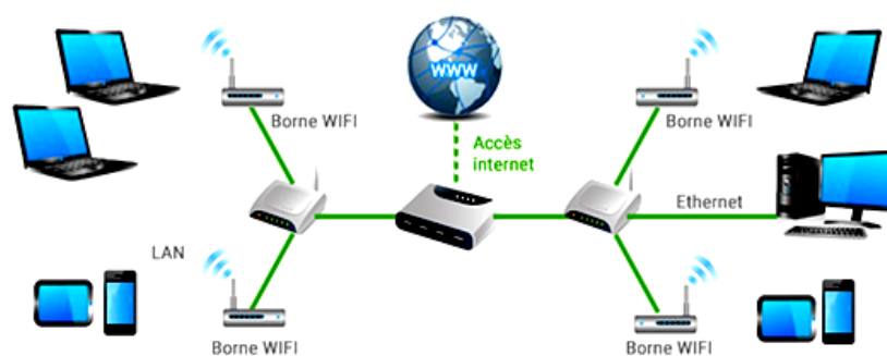
Figure I.12 — Exemple d'un réseau Wifi [2].
