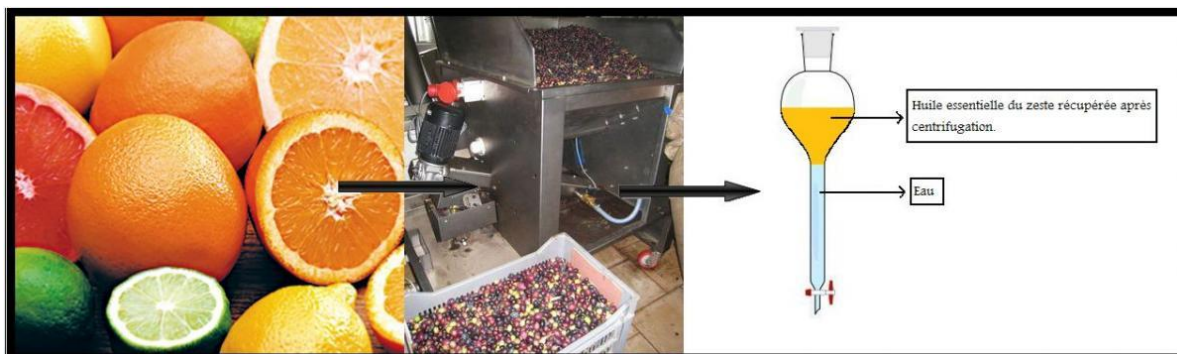
Figure III.3 : Schéma de l'extraction par expression à froid [35].
