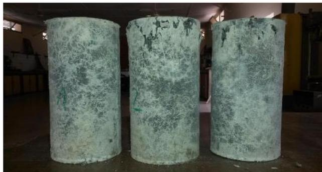
Figure II.18. Eprouvettes de béton de CNP écrasées à 90 jours
