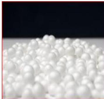
**Figure II.23.** Polystyrène expansé (PSE)
