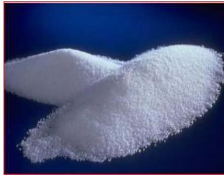
Figure II.19. Polystyrène sous sa forme commerciale
