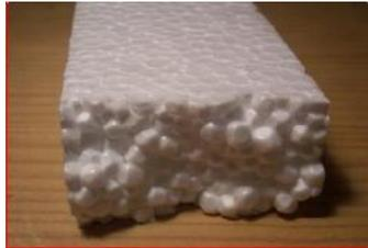
**Figure II.24.** Polystyrène expansé moulé (PSE-M)
