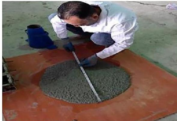
**Figure III.40.** Mesure du diamètre d'écoulement à affaissement pour WS50 [76].
