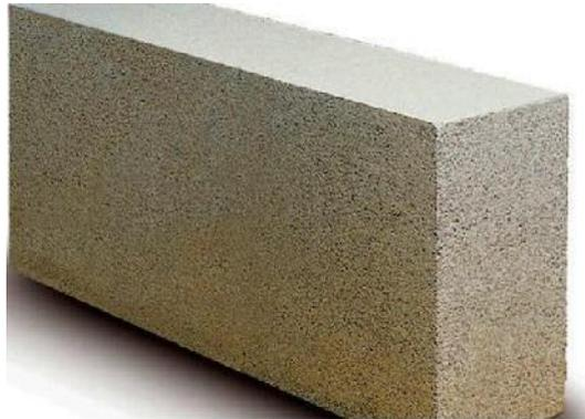
**Figure I.3.** Le béton cellulaire
