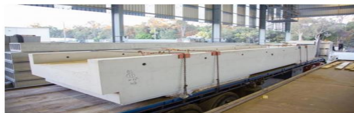
Figure I. 7 : Poutres en béton géo-polymère préfabriqué (Architecture & Design, 2013).
