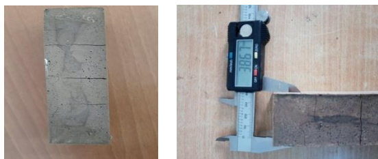
Figure III. 16 fissures des éprouvettes et phénomène de retrait.
