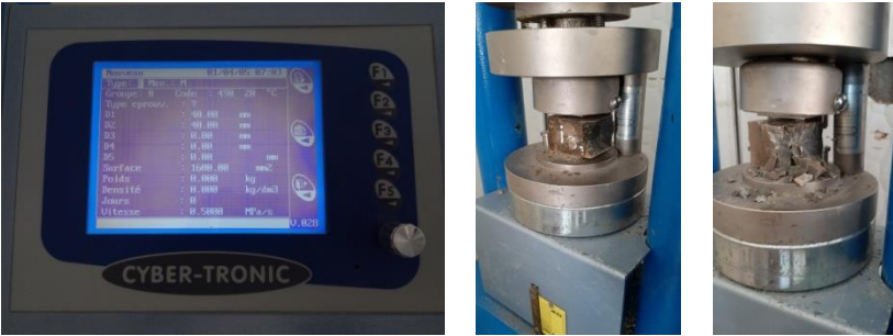
Figure III. 17 presse électro-hydraulique de marque CYBER-TRONIC
