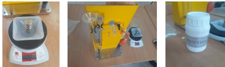
Figure III. 7 Balance analytique. perméabilité de blaine SSB. liquide (Manometre)
