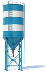
Figure I.4 — Silos à ciment [4].
