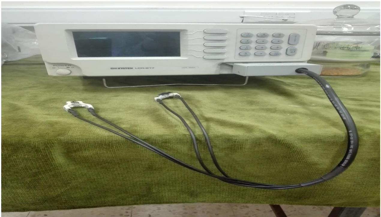
**Figure 3.6.** La spectroscopie d'impédance (LCR mètre).
