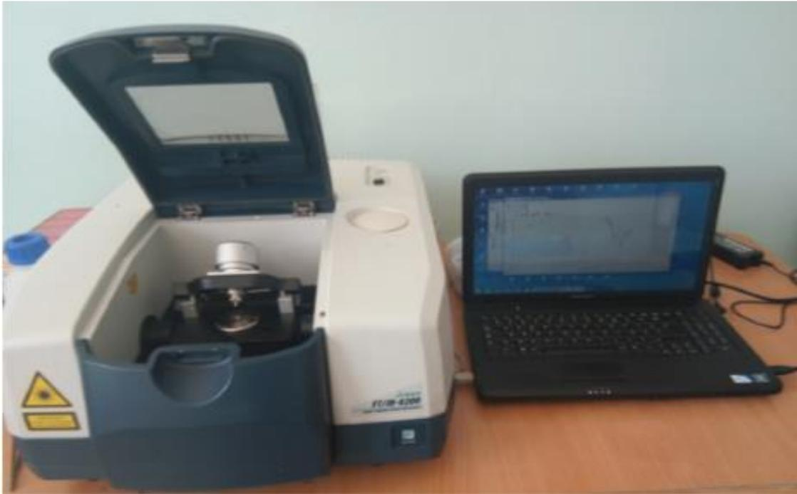
**Figure 3.5.** Schéma du spectromètre (FTIR/ATR).
