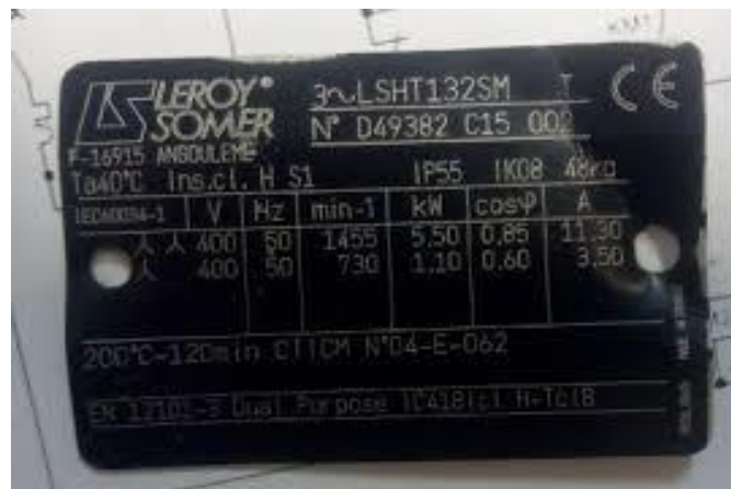
Figure (64) : plaque signalétique d'un moteur asynchrone à 6 bornes
