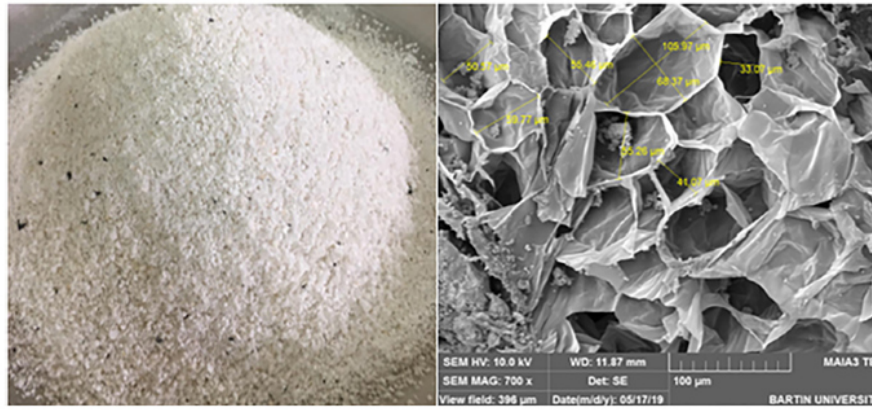
Figure III. 2 :Déchets de poudre de polystyrène expansé et sa microstructure.
