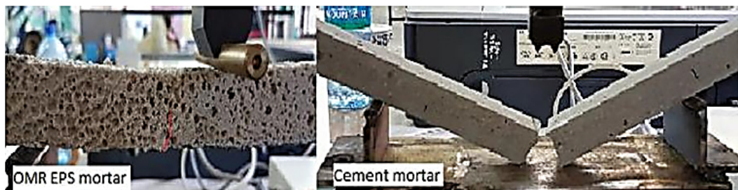
Figure III. 10 : Rupture des éprouvettes lors de l'essai de flexion.
