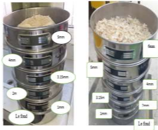
Figure III. 5 : série de tamis utilisée pour tamiser la poudre de bois.
