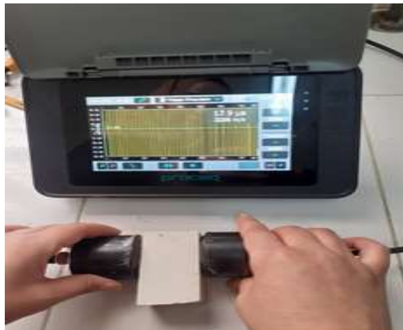
Figure IV. 15 : Disposition de l'essai ultrasonique cas d'une éprouvette en plâtre
