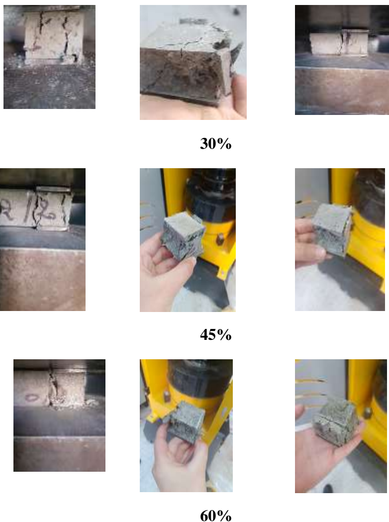
Figure IV. 8 : Modes de rupture des éprouvettes ( 4 \times 4 \times 4 \text{ cm}^3 ) à base de ciment-sciure de bois à la compression uni-axiale.
