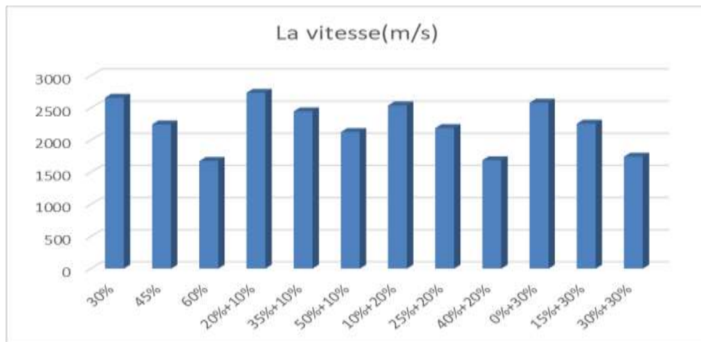
Figure IV. 17 : Représentation graphique des vitesses de propagation ultrasonore dans les composites à base de ciment-sciure de bois.
