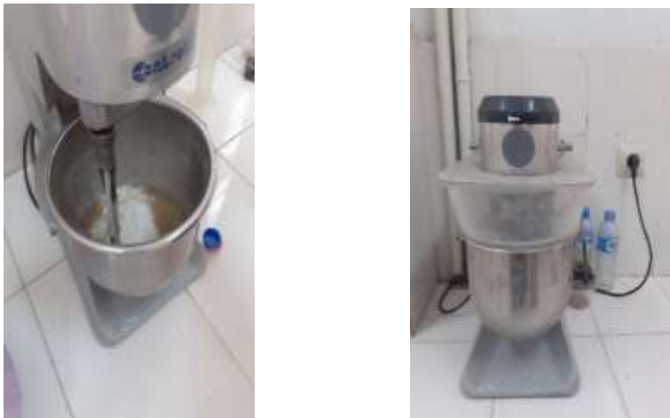
Figure III. 10 : Malaxage du mélange plâtre-sciure de bois.
