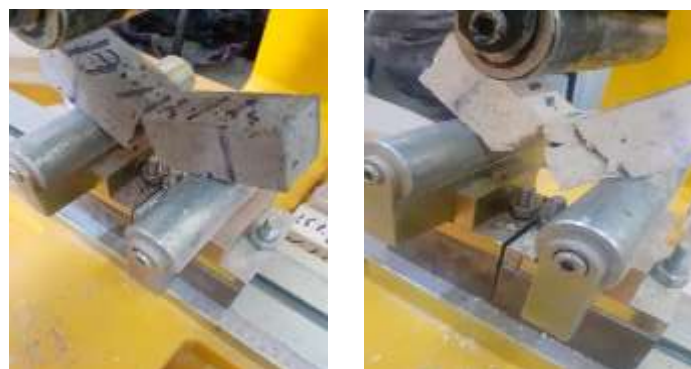
Figure III. 18 : mode de rupture des éprouvettes (4x4x16 cm 3 ) à la flexion 3-points
