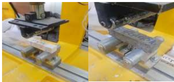
Figure III. 17 : disposition de flexion 3-points des éprouvettes (4x4x16 cm 3 )
