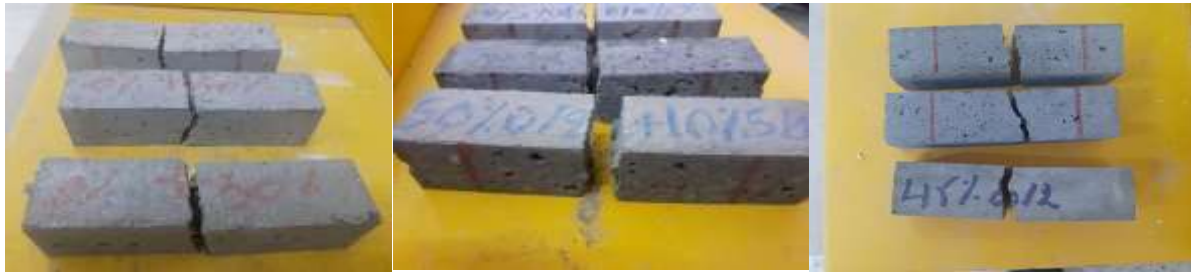
Figure IV. 12 : Modes de rupture des éprouvettes ( 4 \times 4 \times 16 \text{ cm}^3 ) à base de ciment-sciure de bois à la flexion 3-points.
