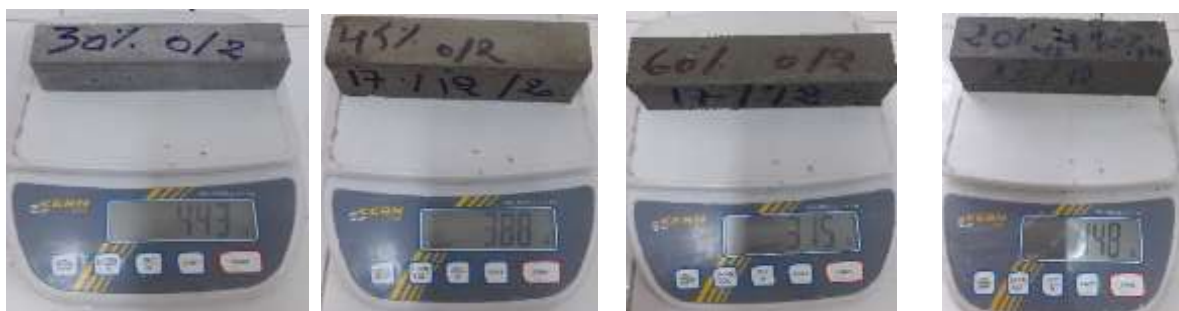
Figure III. 16 : la masse des différentes éprouvettes à base de ciment juste après démoulage
