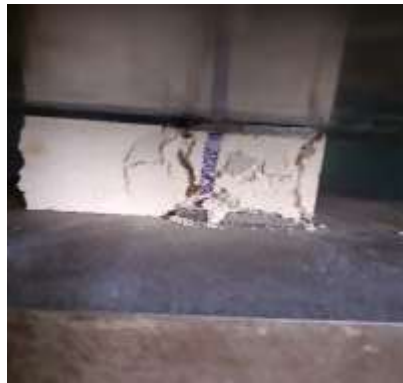
Figure III. 21 : Mode rupture à la compression des éprouvettes (4x4x4cm 3 )
