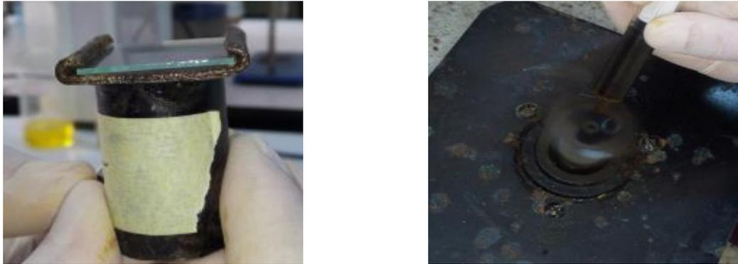
Figure 2.2 : Représente dépôt de la solution sur le substrat
