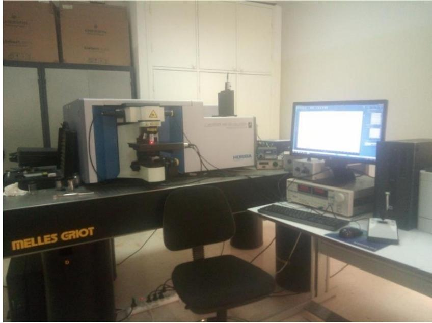
**Figure 2.17: Spectromètre de micro-Raman (confocal LabRamH Revolution' de Horiba Jobin Yvon. CDTA d'Alger).**
