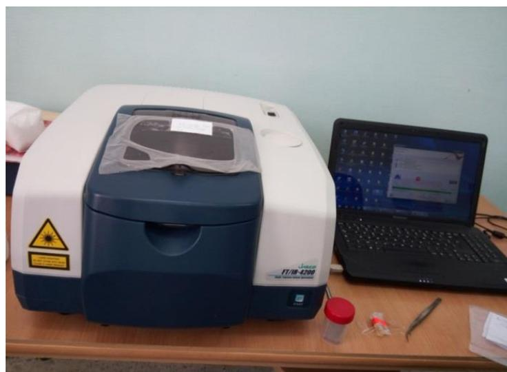
Figure 2.12 : Spectroscopie Infrarouge à Transformée de Fourier
