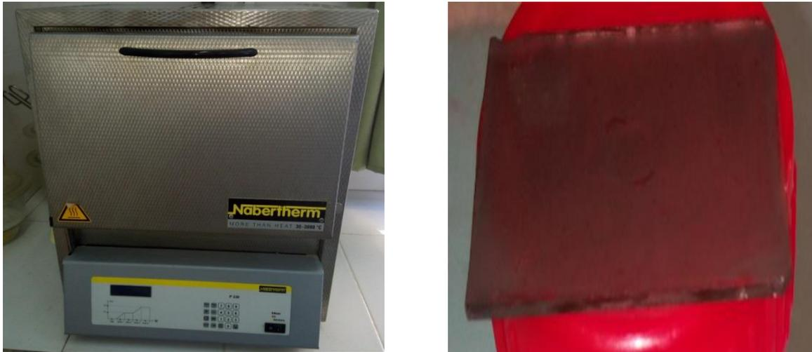
Figure 2.10 : (a) Four à moufle de marque Nabertherm P330, (b) Recuit des films minces.
