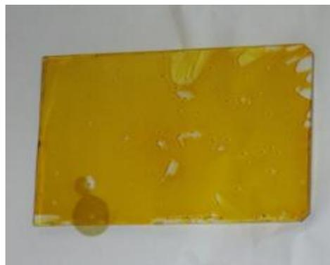
Figure 2.4 : Solution est délattée sur la surface de film mince
