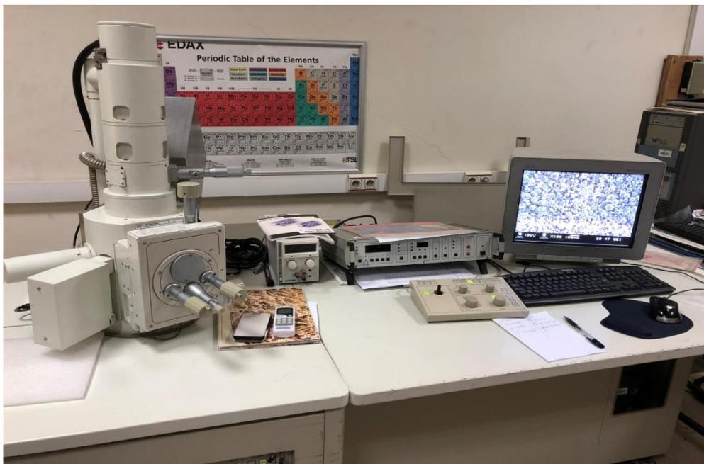
**Figure 2.15** : Microscopie électronique à balayage [de marque JEOL JSM-6360LV.CDTA d'Alger].
