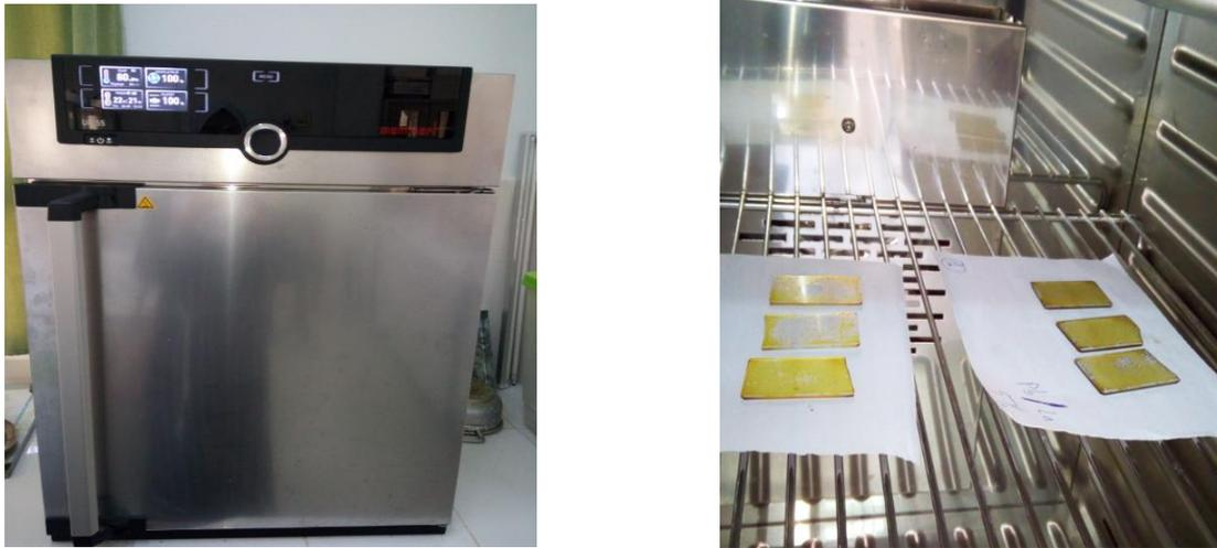
Figure 2.9 : (a) Etuve utilisée pour le séchage (Mettmert UN55- 53L), (b) Séchage des films minces.
