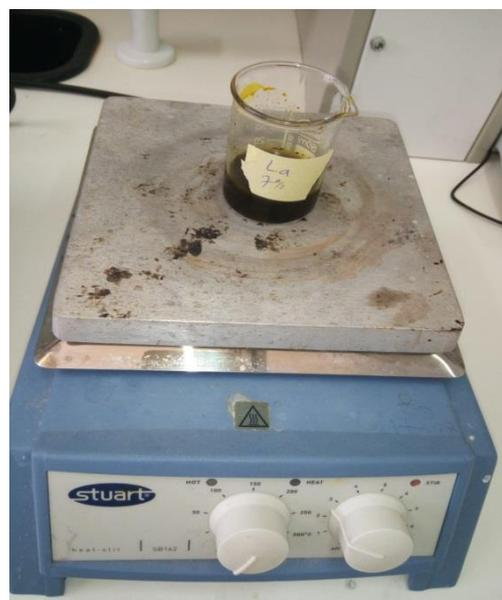
Figure 2.7 : représente l'agitation magnétique d'une solution pure dopées par La à 5% et à 7%
