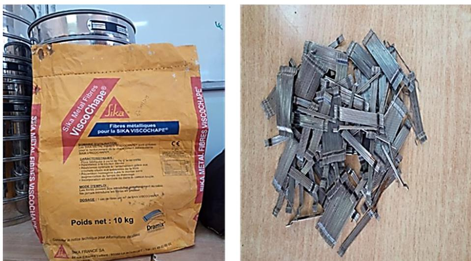
**Figure III. 5**: type de fibre métallique utilisé
