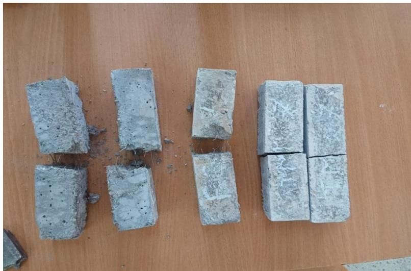
**Annexe 5** : Des éprouvettes de mortier fibrés après l'essai de flexion.
