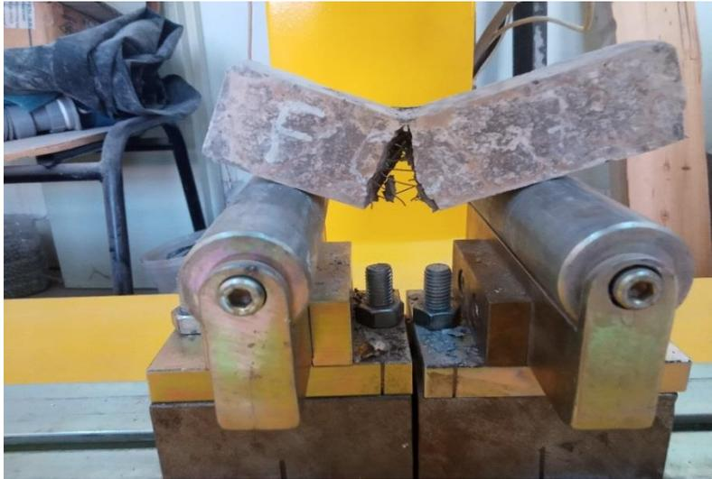
**Annexe 4** : Éprouvette de mortier fibré après la rupture sur l'essai de flexion.
