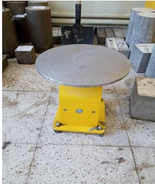
**Figure III. 9:** Table de vibration utilisée
