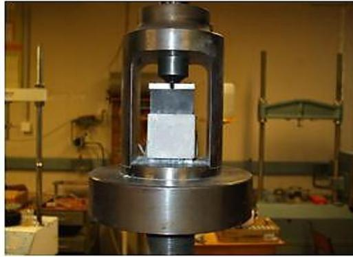
**Figure II. 5:** Essai de compression [25].
