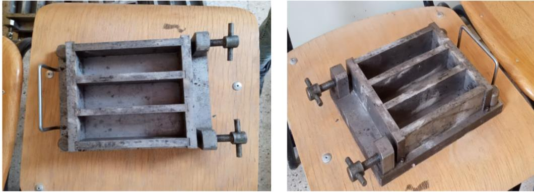
**Figure III. 8:** Moule prismatique utilisé
