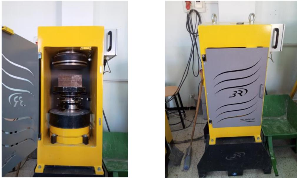
**Figure III. 14:** Presse de l'essai de compression.
