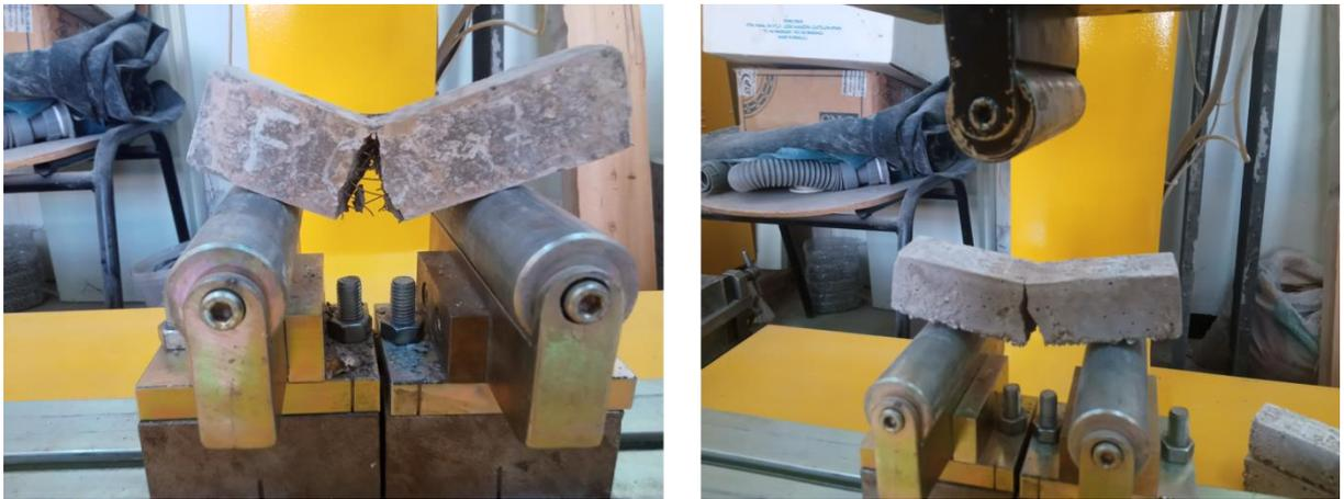
Figure III. 18: Essai de flexion.
