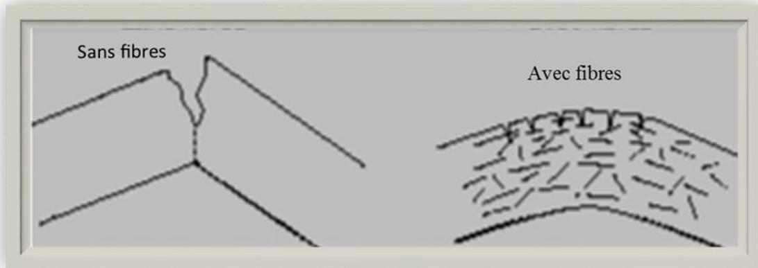
**Figure I. 5:** Fissuration dans le béton sans et avec fibres [6].
