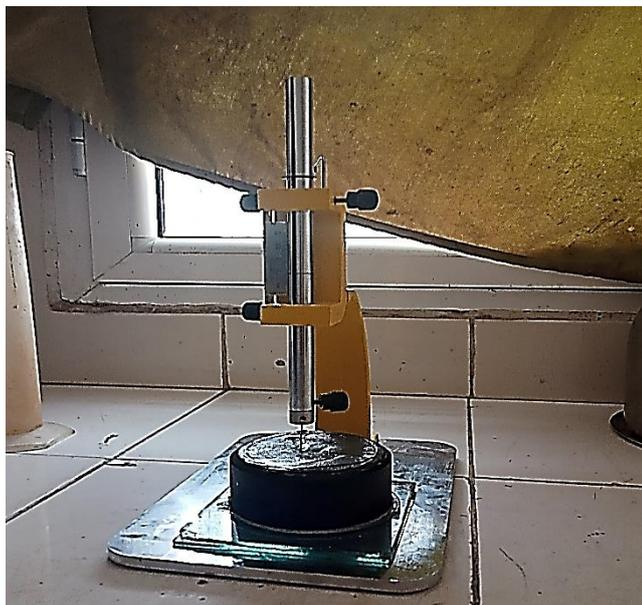
**Figure III. 4:** L'essai de temps de prise
