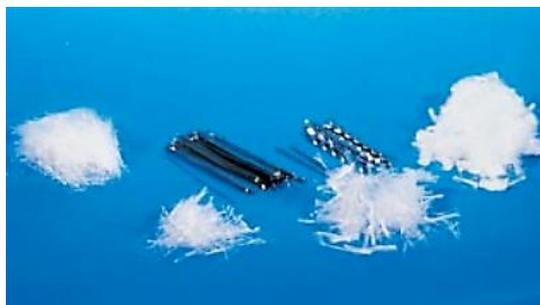
**Figure I. 1** : Des fibres d'acier, de verre, de matériaux synthétiques et naturels de différentes longueurs et formes peuvent être utilisées dans le béton.
