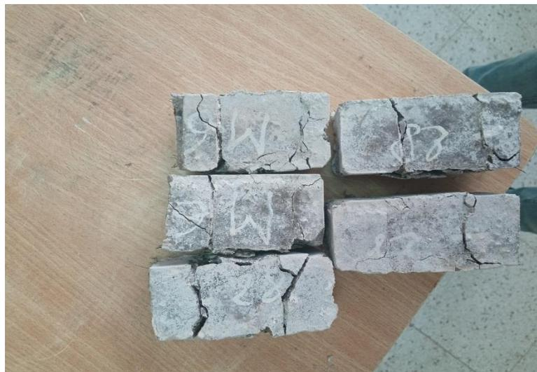
**Annexe 8 :** Des éprouvettes de mortier fibré après l'essai de compression.
