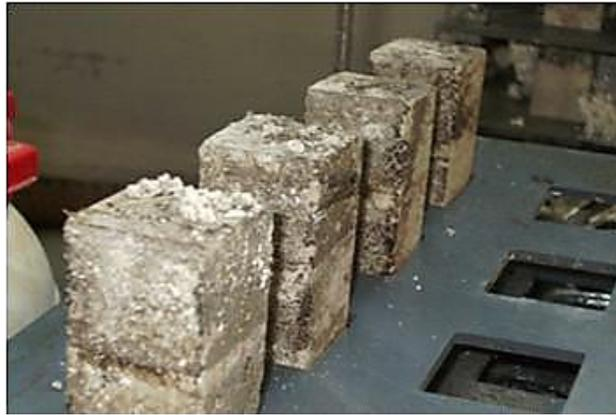
**Figure II. 3 :** Aspect des éprouvettes a la sortie des égouts [25].
