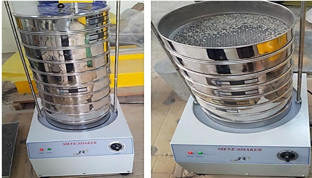
**Figure III. 1:** L'essai d'analyse granulométrique
