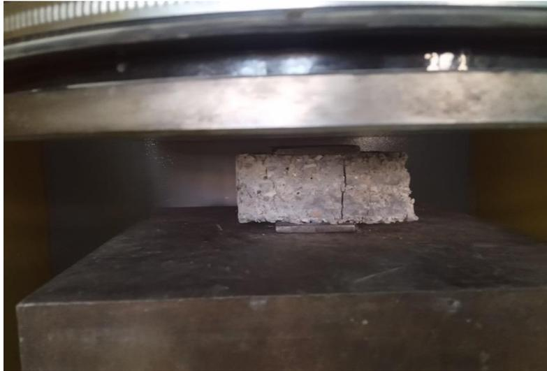
**Annexe 7 :** Éprouvette de mortier fibré après la rupture sur l'essai de compression.
