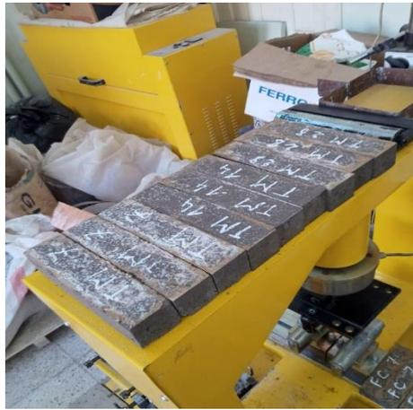
**Annexe 2:** Des éprouvettes de mortiers après le démoulage.
