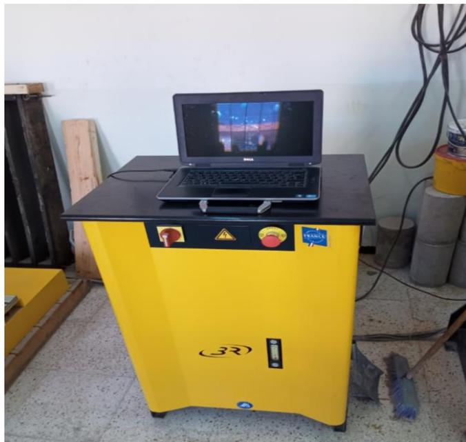
Figure III. 13: La presse de traction par flexion utilisée.
