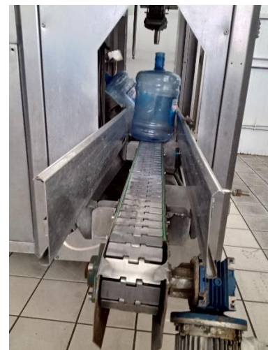
Figure IV.10 : Le tapis de remplissage et bouchonnage.
