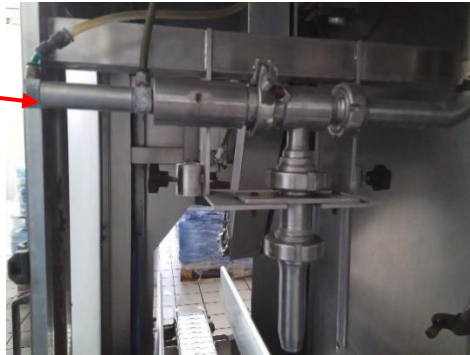
Figure IV.6 : La vanne pneumatique de remplissage.
