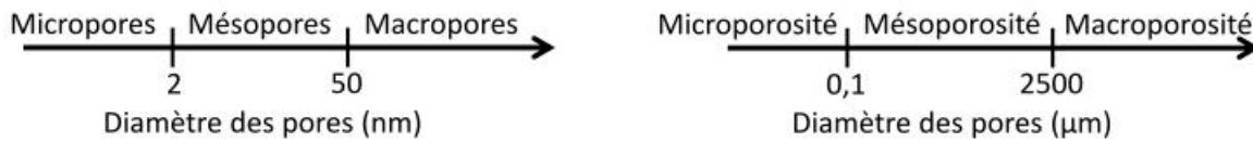
Figure 14. Nomenclature relatives au diamètre des pores et le type d'eau contenue en leur sein, IUPAC.
