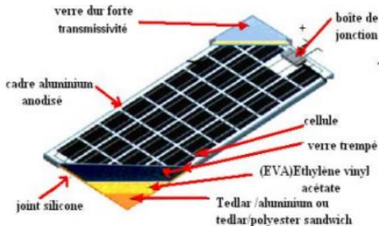
Figure I.9 : Composants d'un générateur PV [12]
