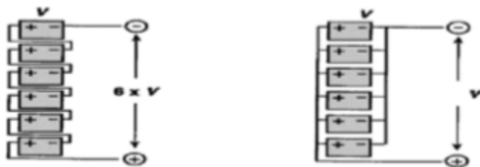
Figure I.19: Connexion des cellules en série (gauche) ou en parallèle (droite).
