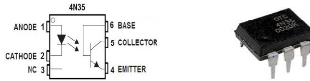
Figure III.13 Circuit intégré et l'image de l'optocoupleur 4N25
