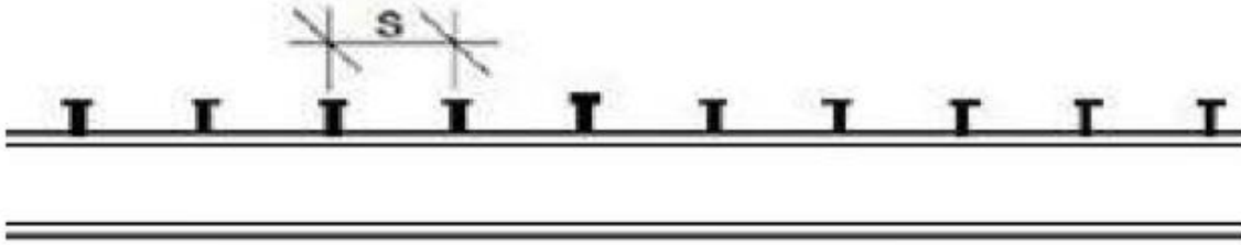
Figure III.2-11 Espacement entre connecteurs.
