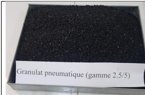
**Figure III-1 .c :** Granulat pneumatique gamme (2.5/5) mm
