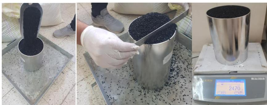
**Figure III-4** : étapes de détermination de la masse volumique
