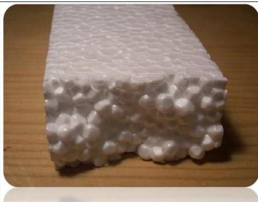
**Figure II-30.** Polystyrène expansé moulé (PSE-M).
