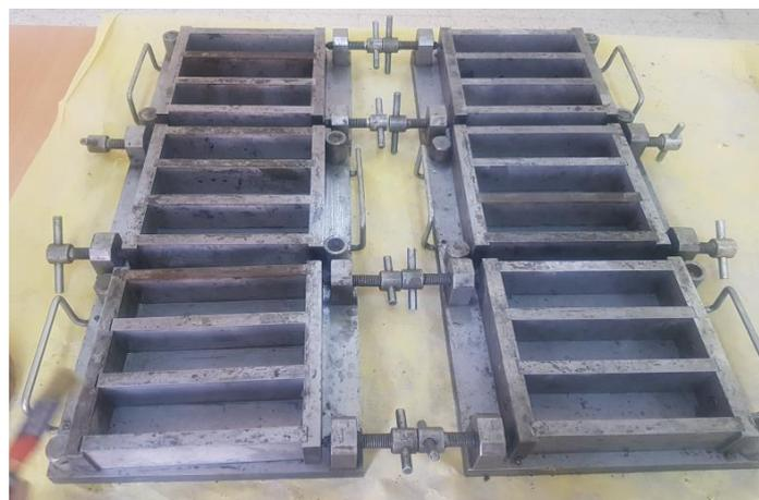
**Figure III-2 :** Les moules utilisés (4x4x16 cm<sup>3</sup>)
