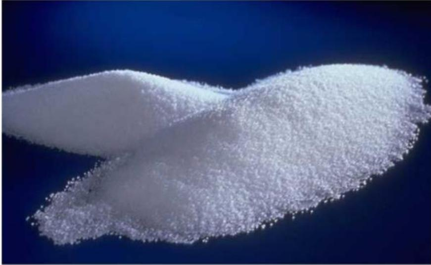
**Figure II-27.** Polystyrène sous sa forme commerciale. [55]
