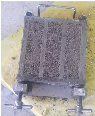
**Figure III-13:** coulage des éprouvettes (4x4x16 cm<sup>3</sup>) à base de (MGDP).
