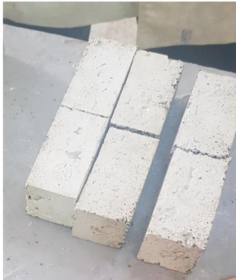
**Figure III-8** : éprouvettes à base de (P/G.P) après la rupture à la flexion
