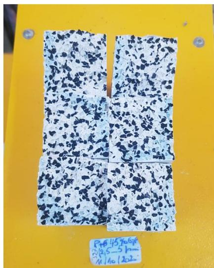
**Figure III-9** la distribution de granulat pneumatique sur le plan de rupture
