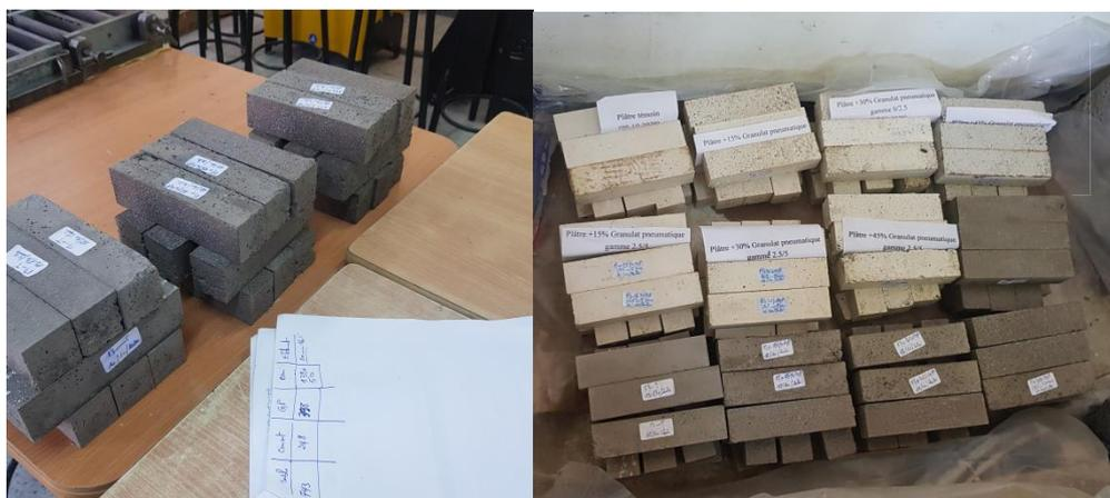
**Figure III-14** démoulage et Conservation des éprouvettes
