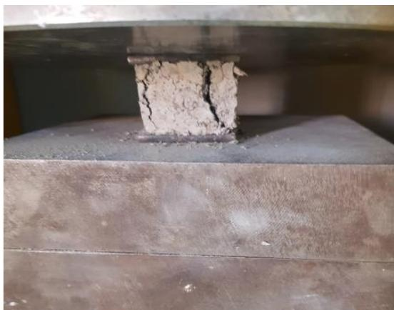
**Figure III-19** mode de rupture à la compression des éprouvettes (4x4x4 cm<sup>3</sup>)
