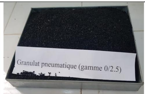
**Figure III-1 .b : Granulat pneumatique gamme (0/2.5)**
