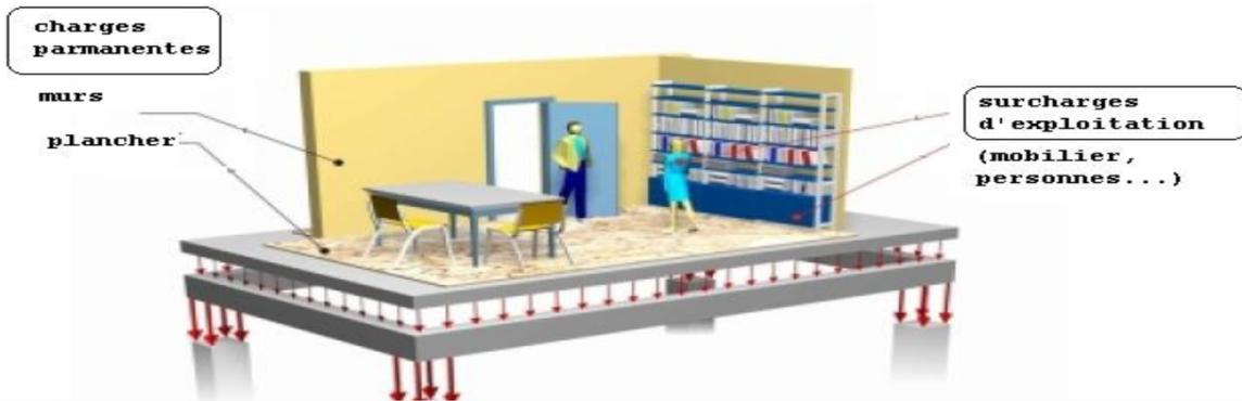
Figure. II.5. Distribution des charges sur les poutres.
